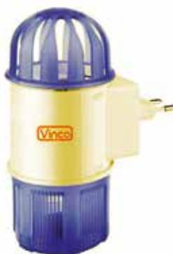
Alimentazione: 220v - a parete - potenza: 4w - 6 led alta efficienza intrappola: insetti ematofagi - dimensioni : 160(h)65x125(p) mm come funziona: attira gli insetti attraverso una lampada uv, il flusso di aria generato dalla ventola al suo interno cattura l'insetto spingendo nell'apposito comparto sottostante.
