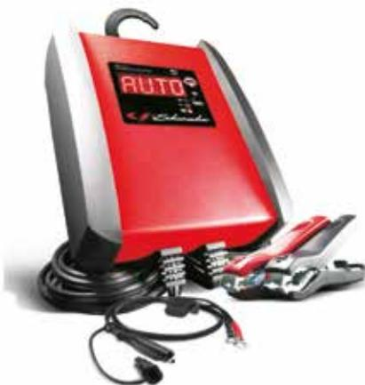
Per batterie 12 v da 5 - 200 ah, controllo a microprocessore per batterie piombo, calcio, start stop agm e gel, funzione mantentore carica rilevamento automatico della tensione e inversione di polarità. dotato di display e funzione di desolfatazione, il display fornisce informazioni su livello di carica ed efficienza alternatore
